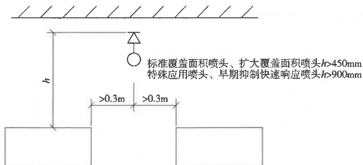
图 14 堆物较高场所通道上方喷头的设置
